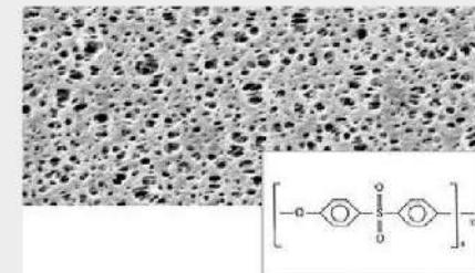
Membran filtreler ürüne zarar vermeden tüm mikroorganizmaları tutar. Steril üretimler için bir kurtarıcı olmuştur. Bu yüzden günümüzde başta ilaç sektörü olmak üzere, meşrubat, doğal kaynak sulular gibi sıvılar ile suda çözünen gıdaların üretiminde vazgeçilmez bir yöntem olmuştur. Membran filtreler, kullanım alanlarına göre farklı materyallerden üretilmekteyler.
