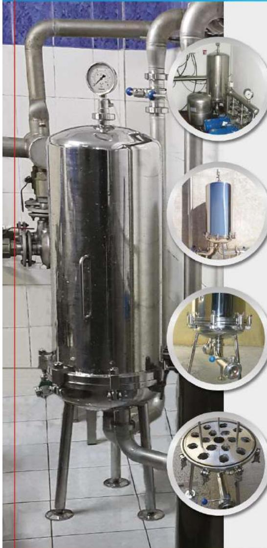
"Membran" kelimesi Latincede "zar" demektir. Membran filtre belirlenmiş büyülükte gözenek çapına sahip ve bu gözenek çapından büyük partikül ve mikroorganizmaları geçirmeyen mutlak filtrelerdir. Membran filtrenin basınca dayanıklı, gözenek büyülükleri mikron seviyesindedir. Sık gözenekli sünger görünümlü bir yapıya sahiptir. Membran filtreler 0,1 µm ile 10 µm arasında değişen gözenek çaplarında üretilmektedir. Membran filtreleme fiziksel bir filtrasyondur.
